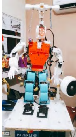
Ilustración 3: SOPORTE DE ROBI 3.6 IMPRESO
