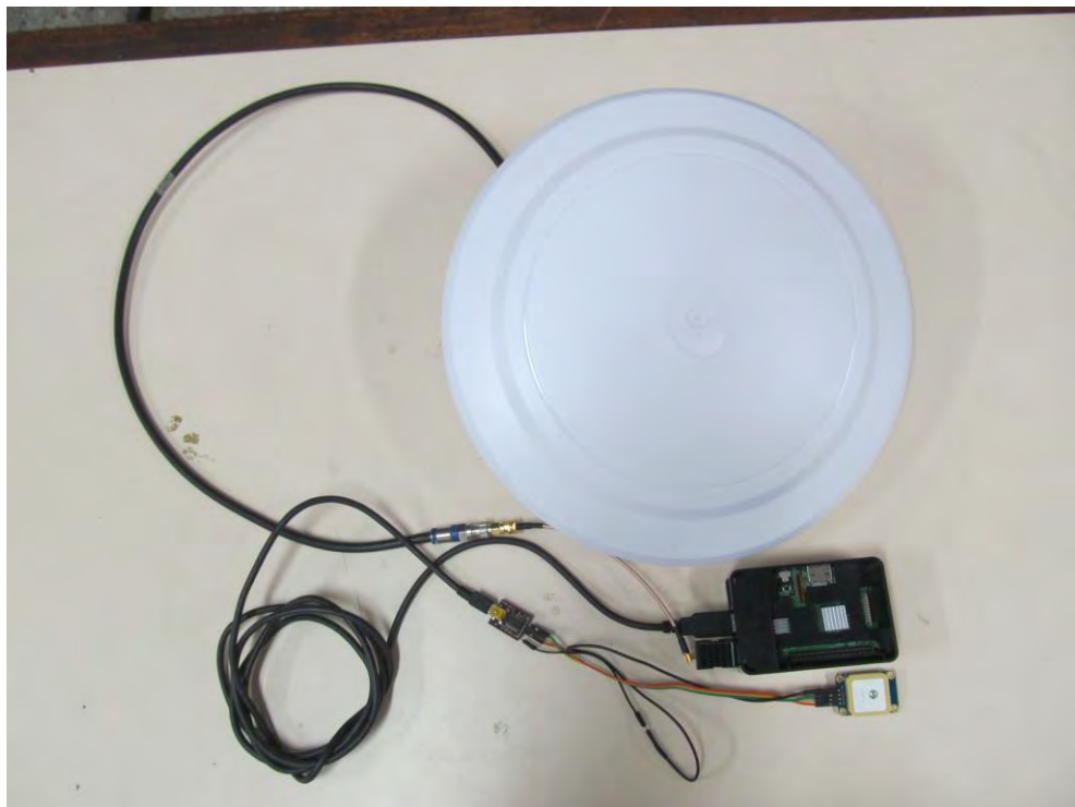
Fig. 7 Analizador Espectral de Bajo costo Implementado.
