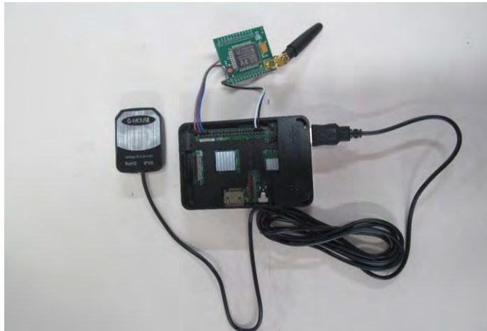
Fig. 8 Conexión de Módulo GSM y Raspberry PI
