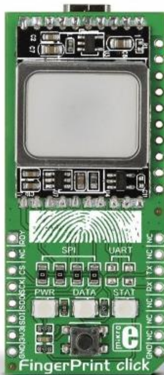
Lector biométrico con controlador incorporado
