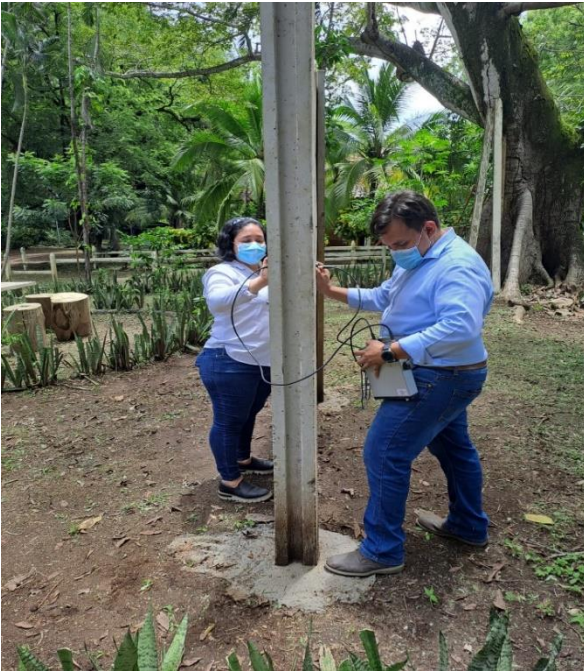
Ensayo de pulso ultrasónico en placas de concreto tradicional
