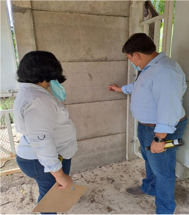
Ensayo de numero de rebote en placas de concreto PET
