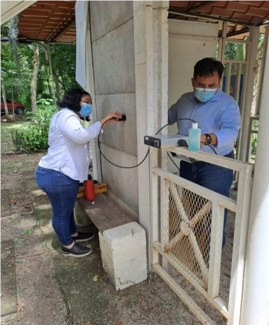
Ensayo de pulso ultrasónico en placas de concreto PET
