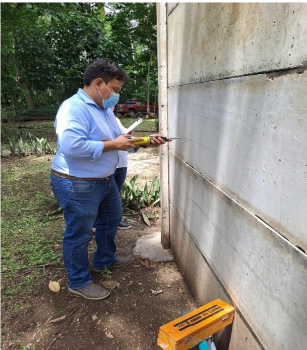
Ensayo de numero de rebote en placas de concreto tradicional
