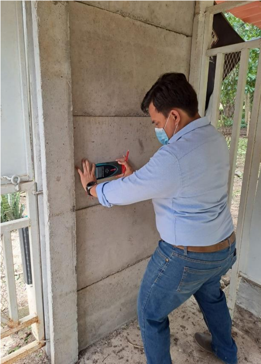
Delineamiento del acero de refuerzo en placas de concreto PET
